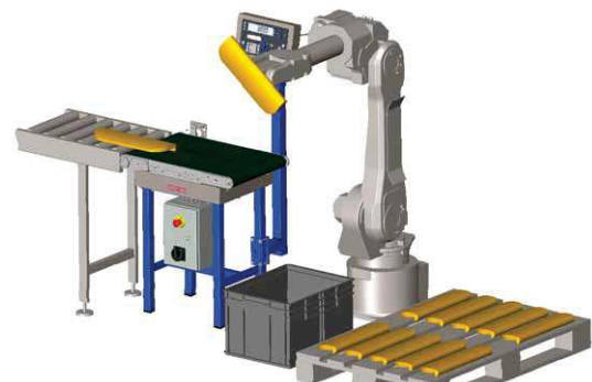
zur Ausschuss-Steuerung bei Roboter Palettierung
